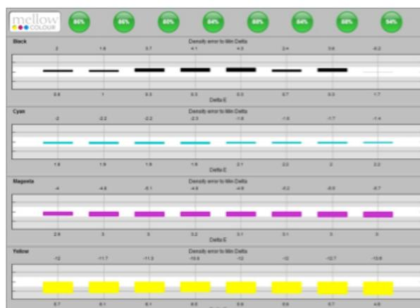
Die Mellow Colour FlatLine-Software zeigt die Farbeinstellung an, um die Standard- oder MinDelta-Dichten sowie DeltaE-Werte für jede Zone zu erreichen. Zusätzliche Berichte stehen ebenfalls zur Verfügung.
